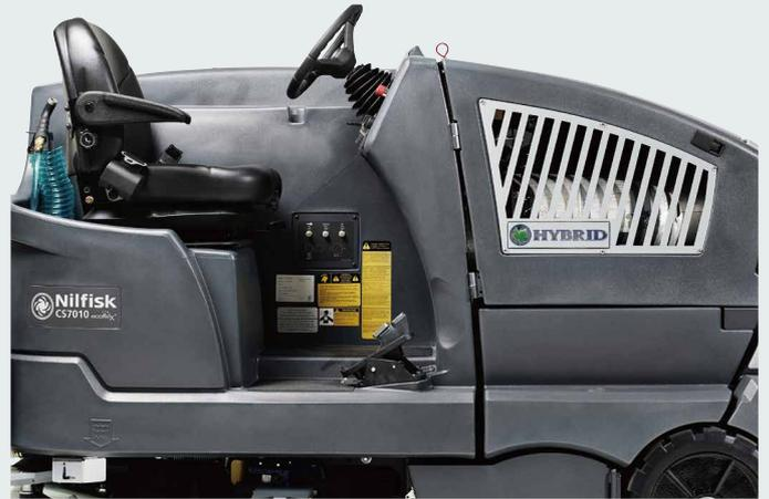
CS7010采用完全可调的座椅和倾斜的转向装置
