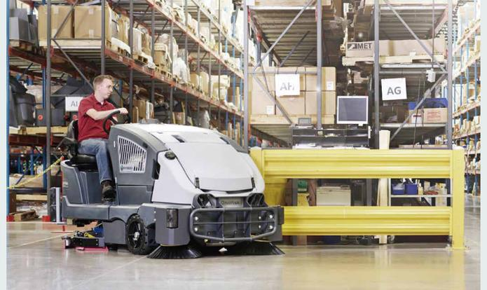
转弯时可自动减速，提升了安全性，降低冲击损坏的风险
