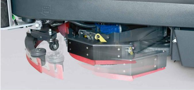
可收缩的偏置式圆盘刷头（长10cm）能增强边缘擦洗能力，并抵抗意外冲击造成的损坏
