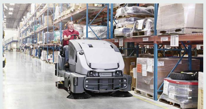
SmartFlow™采用水和化学品，可随着机器的速度调整清水流量。倾倒与加注循环次数更少，生产效率更高
